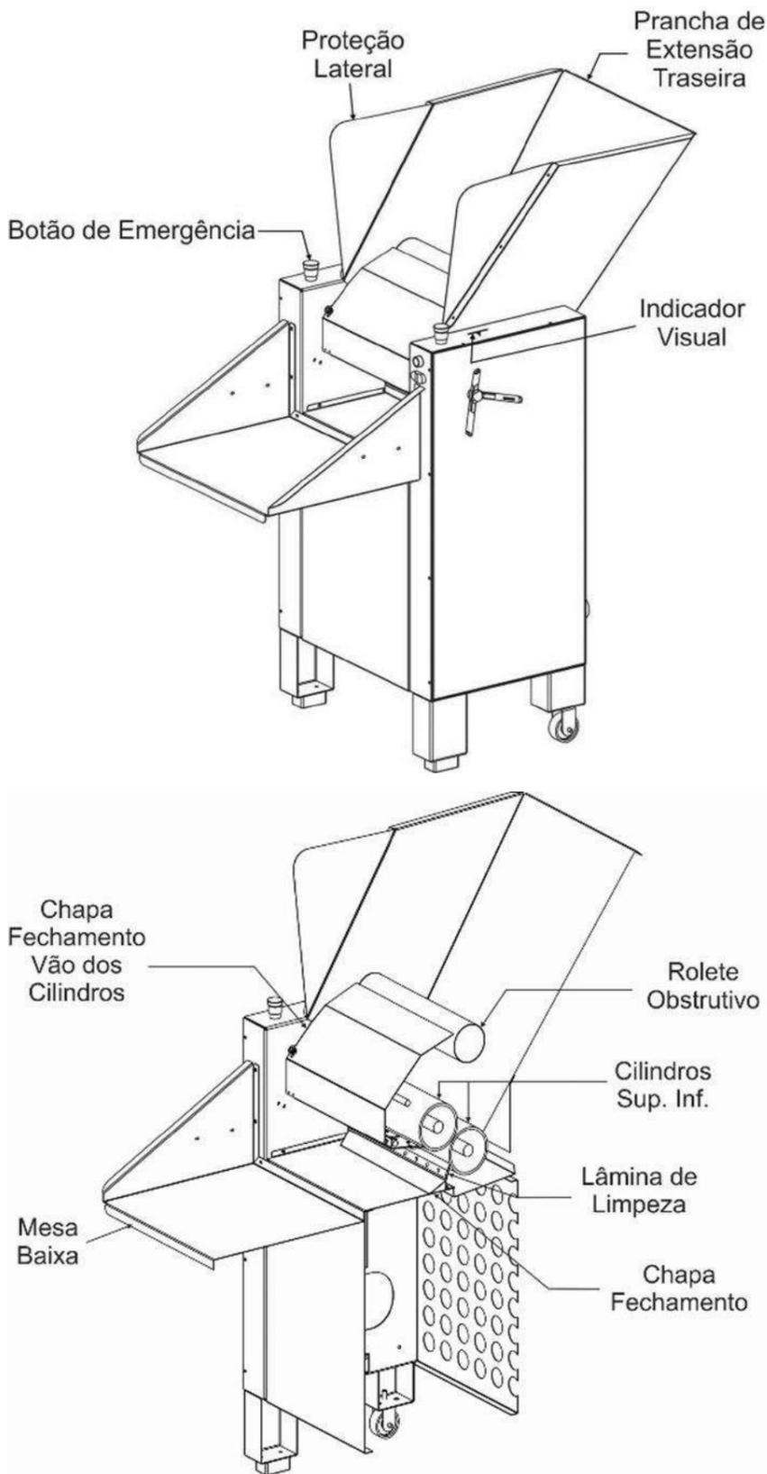
Figura 1: Representação esquemática do cilindro soador.
